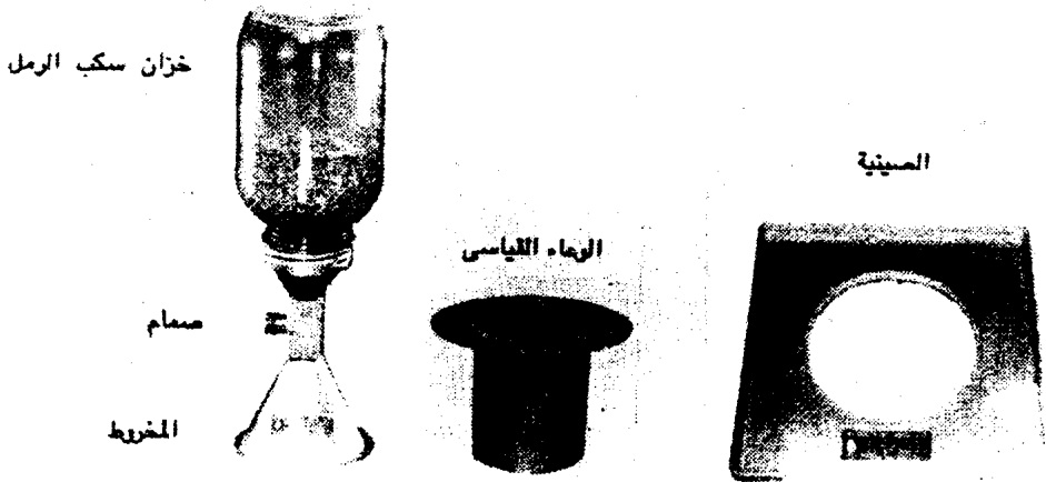
شكل (١٠-٤) جهاز المخروط الرملى لتعيين الكثافة الحقلية للتربة الرملية أو الزلطية
